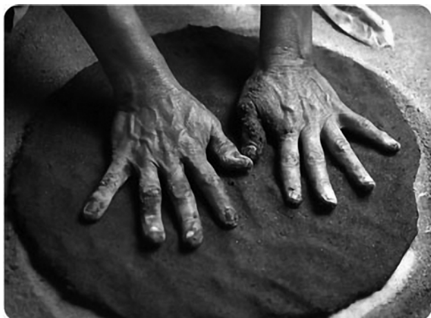
slika 2. Priprema glinenog testa na radnoj površini preko koje je prosut pesak kako se ne bi lepilo.
